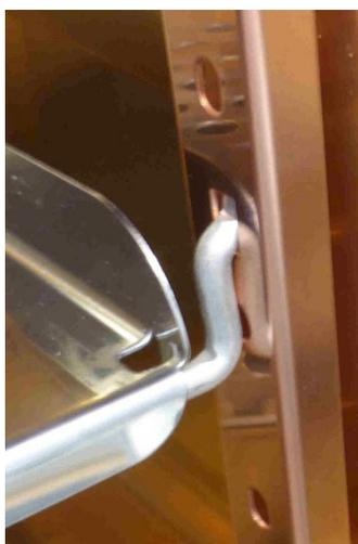
Figura: Installazione del ripiano perforato
