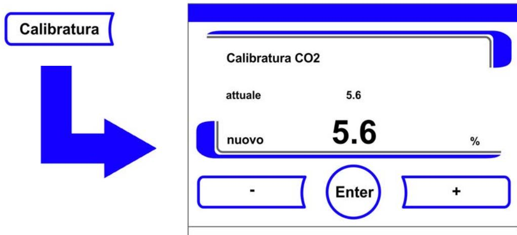
**Figura 9-5.** Calibrazione della CO<sub>2</sub>
