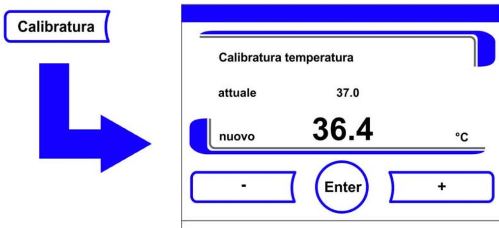
**Figura 9-3.** Procedura di calibrazione temperatura
