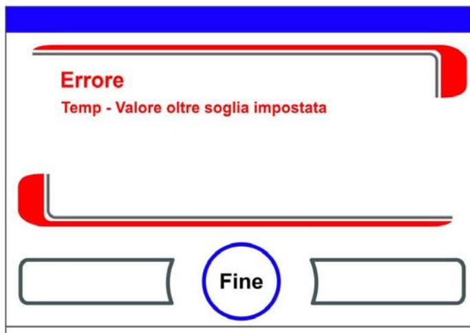
**Figura 6-52.** Messaggio di errore Sovratemperatura
