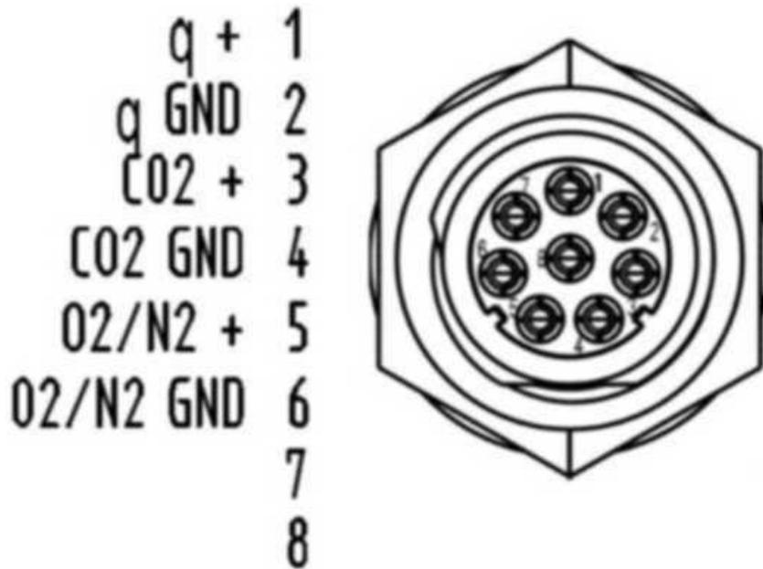
**Figura 4-15.** Asignación de las conexiones de la interfaz de 4-20 mA
