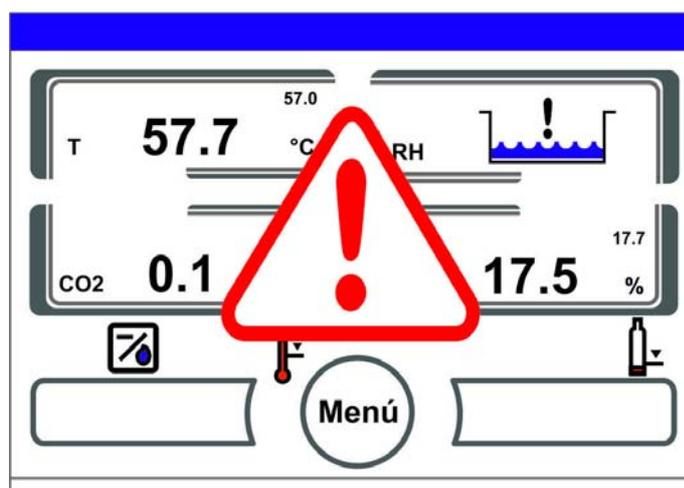
Figura 6-51. Mensaje de error sobretemperatura
