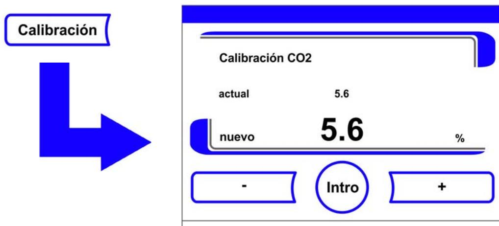
**Figura 9-5.** Ejecutar la calibración de CO<sub>2</sub>
