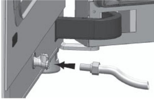
**Figura 3-13.** Válvula de llenado/vaciado de la incubadora
