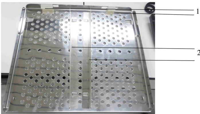
Figura: Bandeja perforada con los rieles guía no separados
