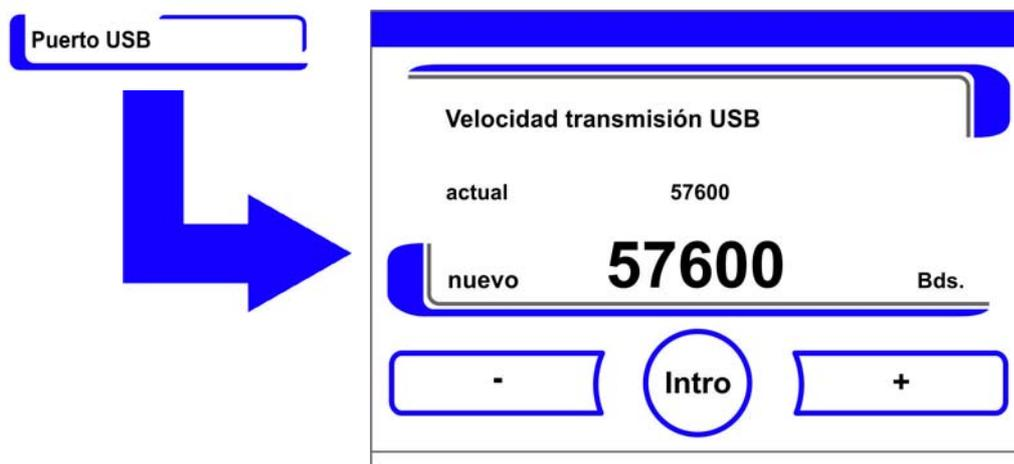
Figura 6-27. Ajustar la velocidad en Baudios de la interfaz USB
