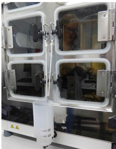
**Figura 5-3.** Embudo de relleno
