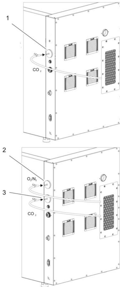
**Figura 4-12.** Conexión del gas
