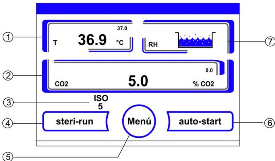
**Figura 6-3.** Pantalla táctil iCan™ sin suministro de gas O<sub>2</sub>/N<sub>2</sub>
