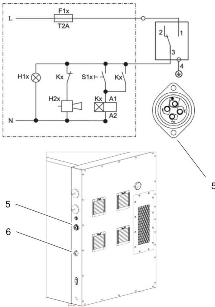
**Figura 4-14.** Ejemplo de conexión del contacto de alarma
