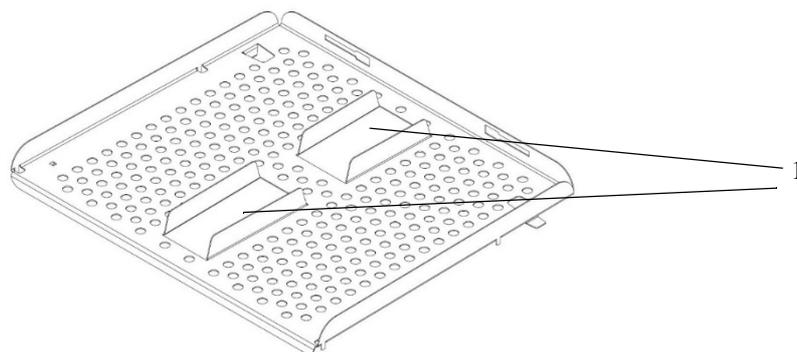
Figura: Bandeja perforada con rieles guía separados para la posición inferior
