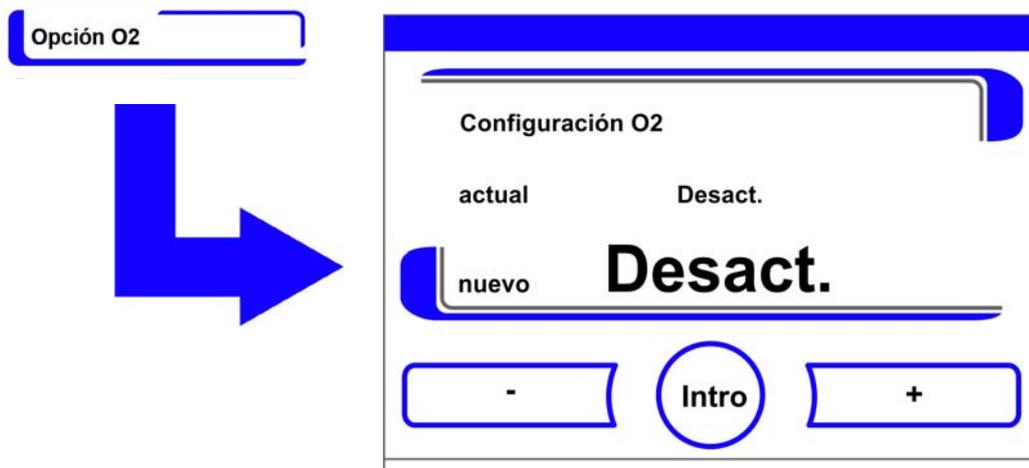
**Figura 6-42.** Conectar / desconectar la regulación O<sub>2</sub>
