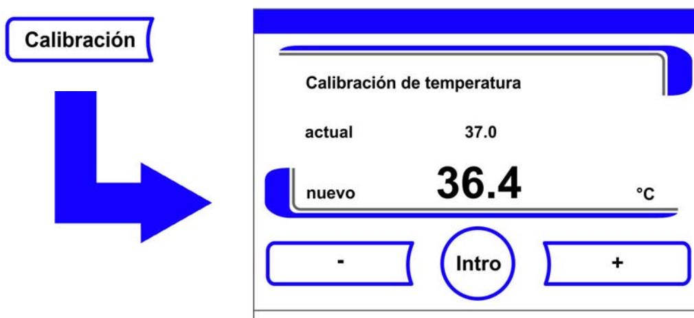
Figura 9-3. Ejecución del ajuste de la temperatura
