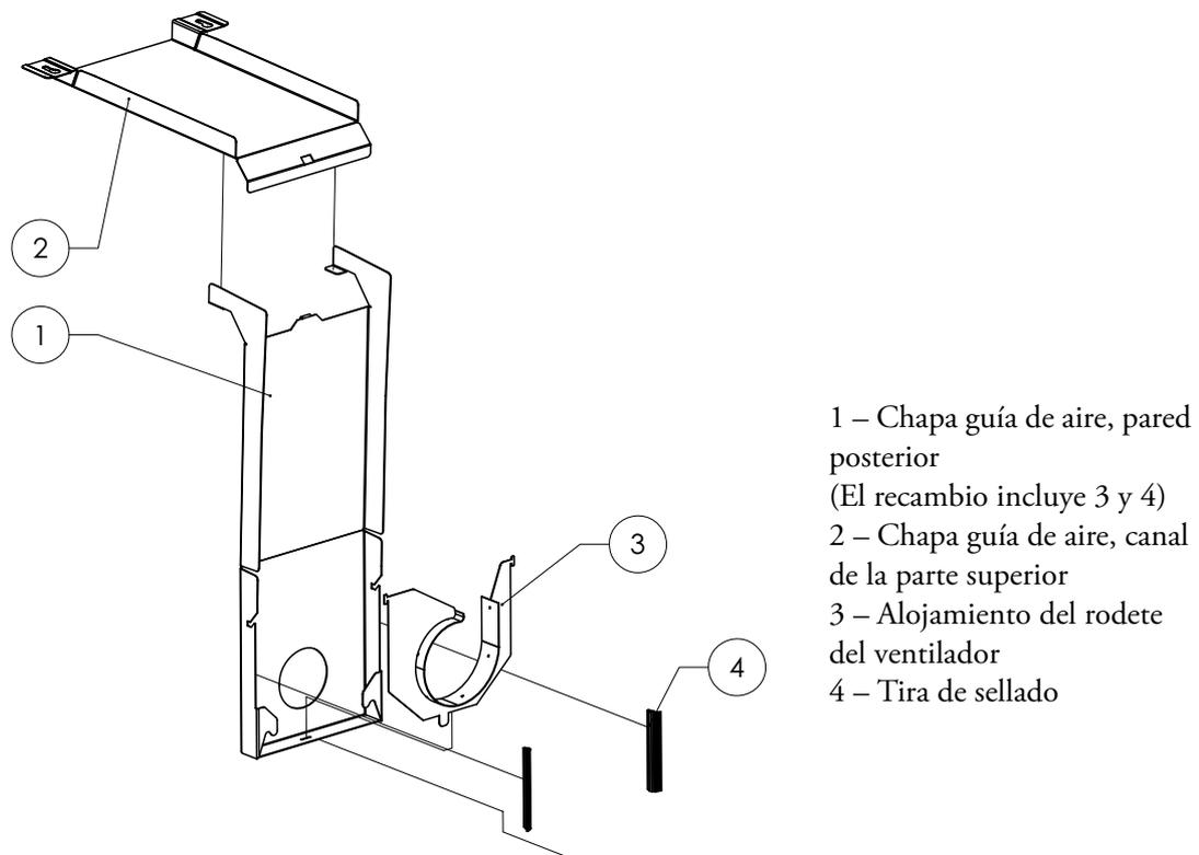
**Figura 4-4.** Componentes de la conducción de aire **HERACELL VIOS 160i CR**
