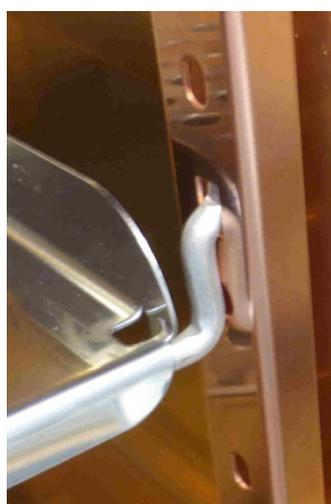
Figura: Instalación de las bandejas perforadas
