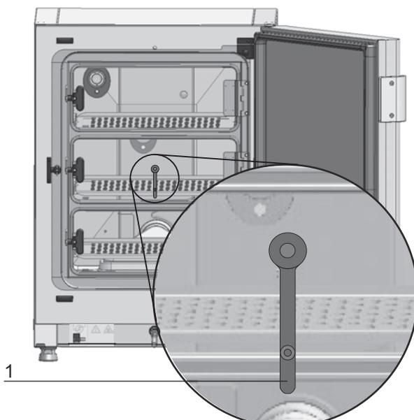
**Figura 9-4.** Abertura de medición de los paneles protectores
