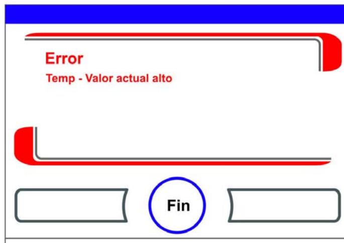
**Figura 6-52.** Mensaje de error sobretemperatura
