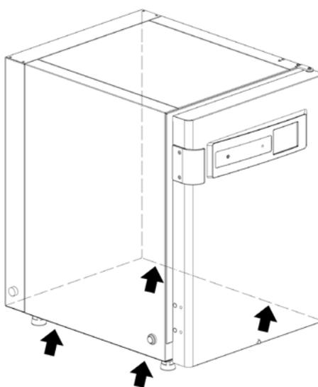
**Figura 2-2.** Puntos de elevación
