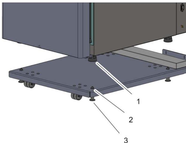
**Figura 2-7.** Armazón de apoyo con ruedas y sin pies de apoyo (versión 160i)
