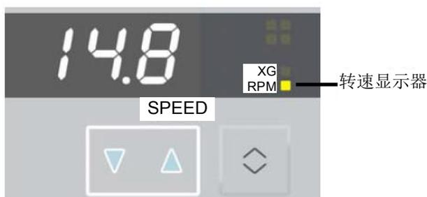
2. 当上指示器被点亮时，显示器将显示 RCF 值。按
