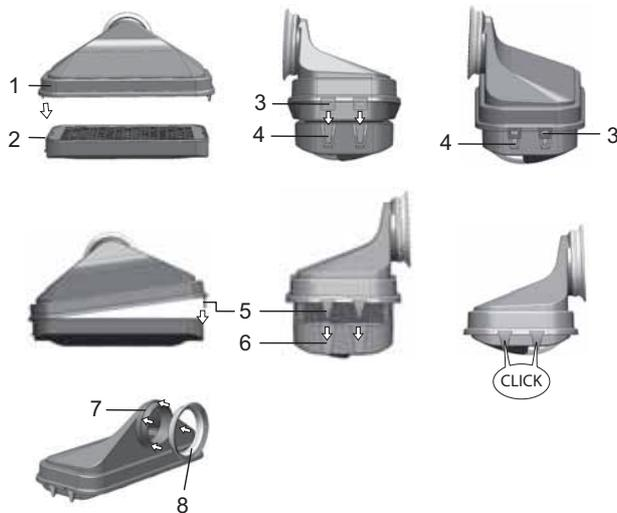
**Abbildung 7-6** HEPA-Filter einbauen
