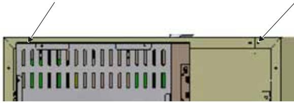
**Abbildung 3-6** Schrauben für die Trägerrahmen entfernen
