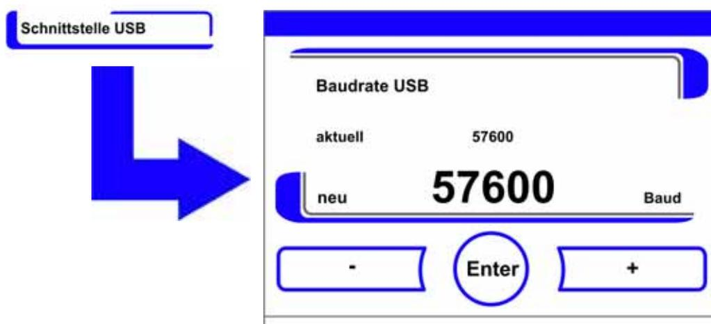
**Abbildung 5-34** Baudrate USB-Schnittstelle einstellen
