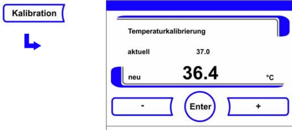
**Abbildung 7-3** Temperaturabgleich durchführen
