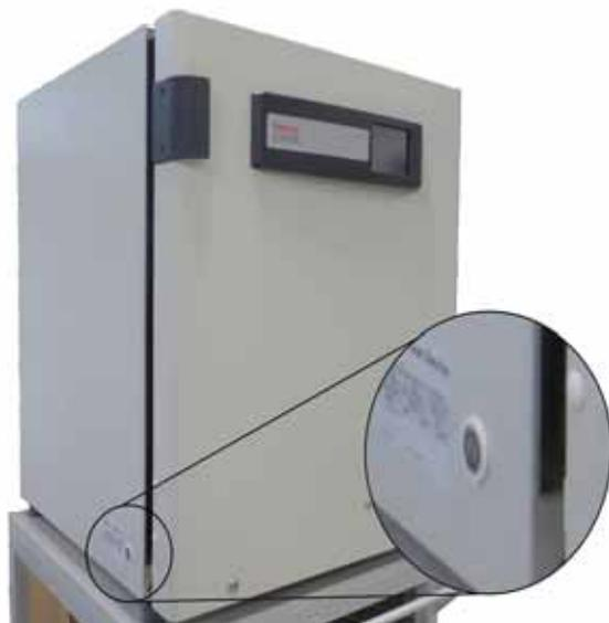
**Abbildung 5-9** Netzschalter
