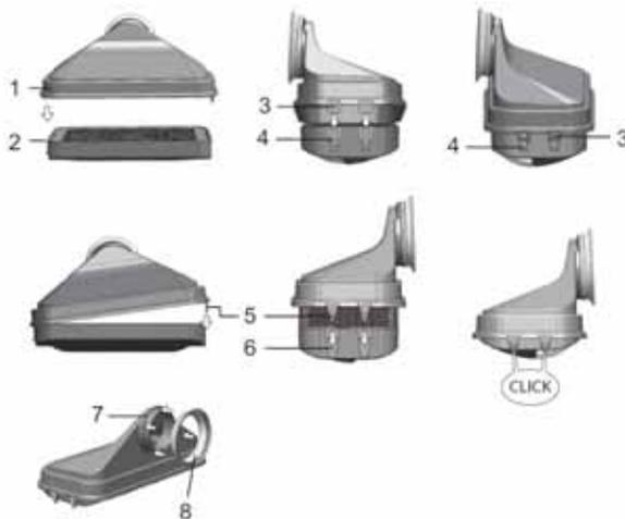
Abbildung 2-5 HEPA-Filter und Airbox
