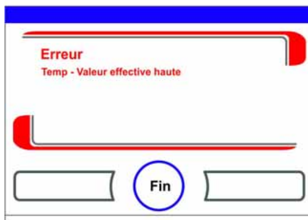
Figure 5-58 Message d'erreur de sur-chauffe
