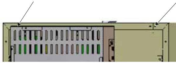
Figure 3-6 Retrait des vis des supports muraux
