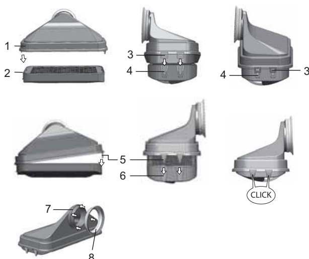
Figure 7-6 Montage du filtre HEPA
