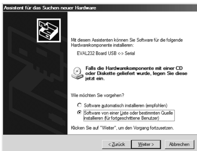
Figure 10-3 Installation du pilote de port USB_2
