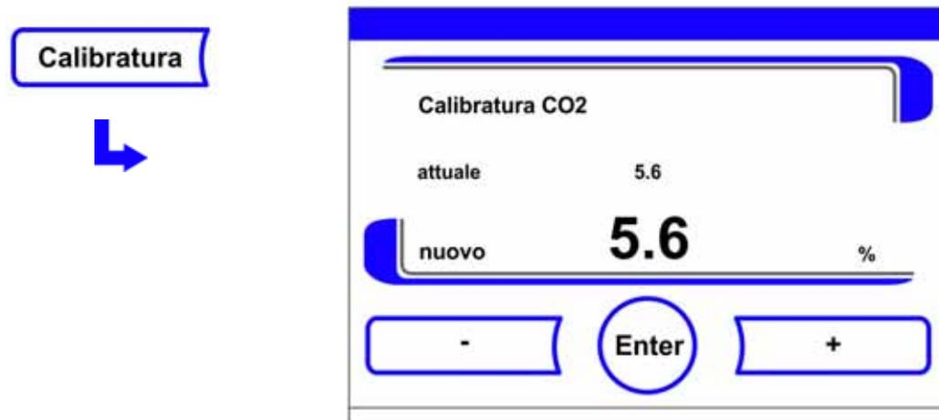
**Figura 7-4** Calibrazione CO<sub>2</sub>
