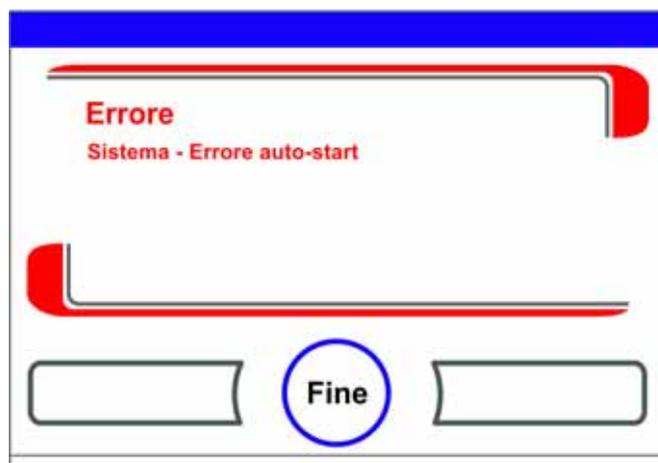
**Figura 5-23** Messaggio di errore dopo l'interruzione di auto-start
