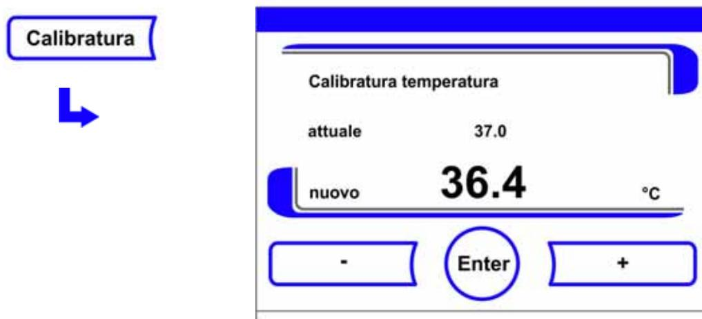
**Figura 7-3** Procedura di calibrazione temperatura
