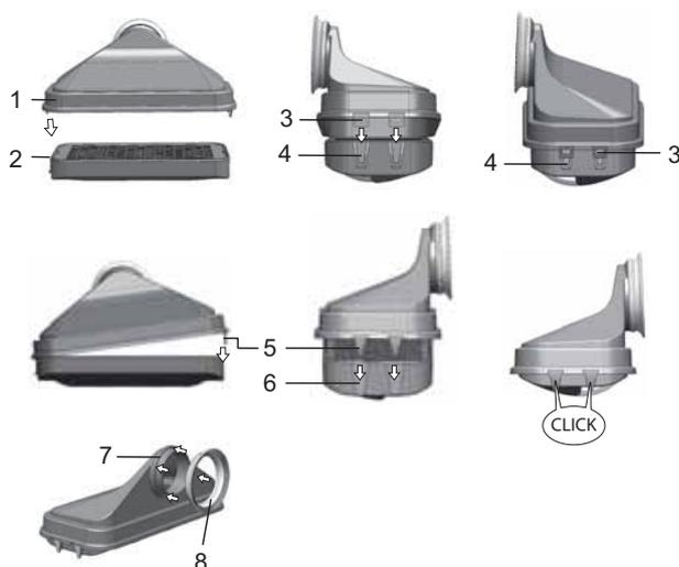
**Figura 7-6** Montaggio del filtro HEPA
