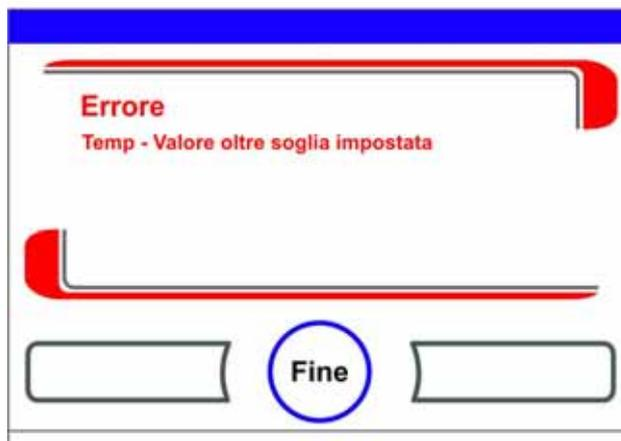
**Figura 5-58** Messaggio di errore Sovratemperatura
