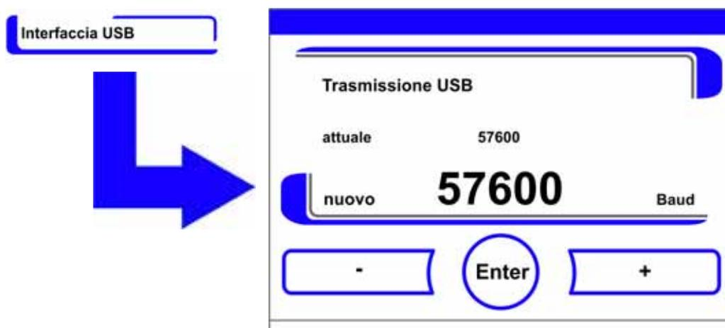
**Figura 5-34** Impostazione del baud rate della interfaccia USB
