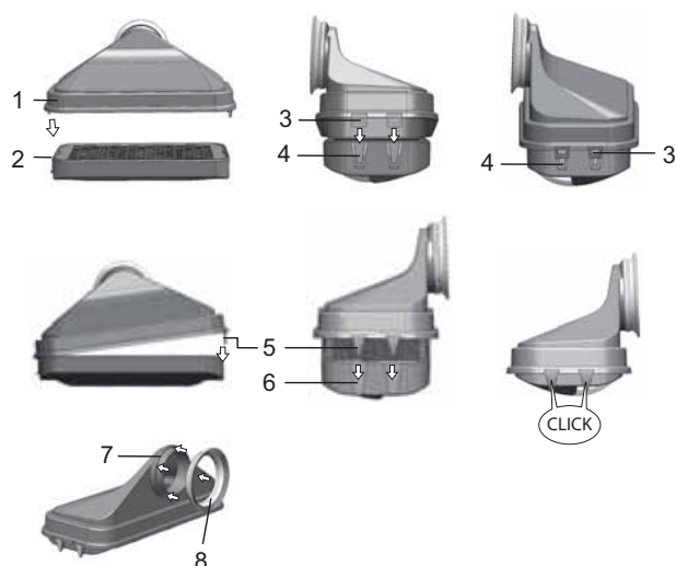
图 7-6 安装 HEPA 过滤器
