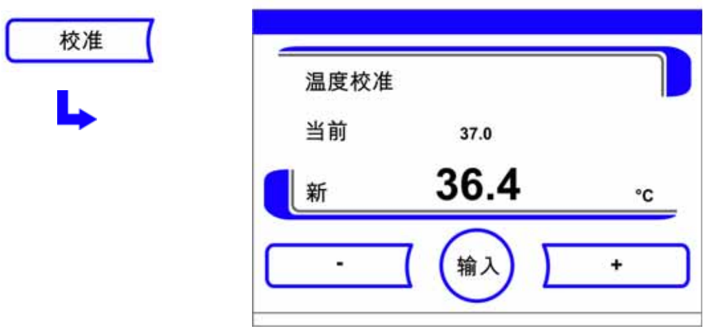
图 7-3 温度校准过程
