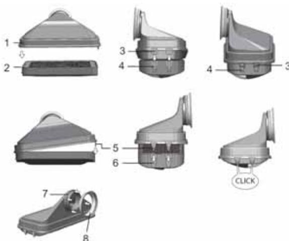
図 2-5 HEPA フィルターとエアボックス
