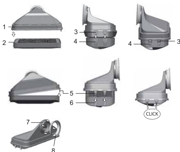
Рисунок 7-6 Установка фильтра HEPA
