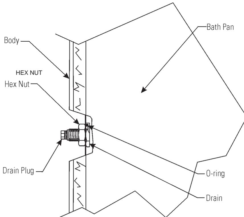
**CUTAWAY VIEW OF DRAIN**
