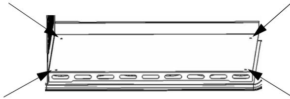
**Abbildung 5-6 Ausbauen des Bodenblechs**
