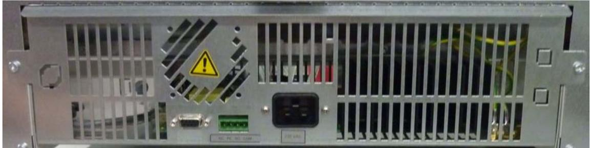
**Abbildung 5-9 Netzanschlussbuchse**
