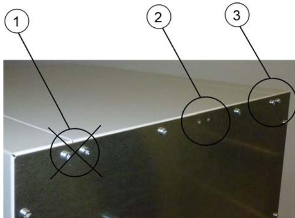
1. Position nicht verwenden, wenn sich auf dieser Seite der Anschlag für die Gerätetür befindet. Der Türanschlag rechts ist die Standardausführung.
