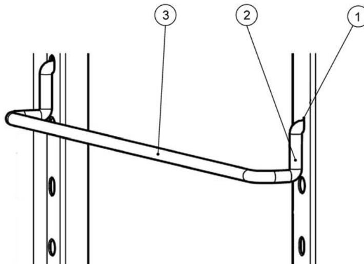
Abbildung 5-4 Einbau der Auflagebügel
