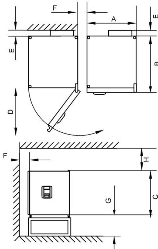
Abbildung 3-1 Maße und erforderliche Seitenabstände des Tischgerätes
