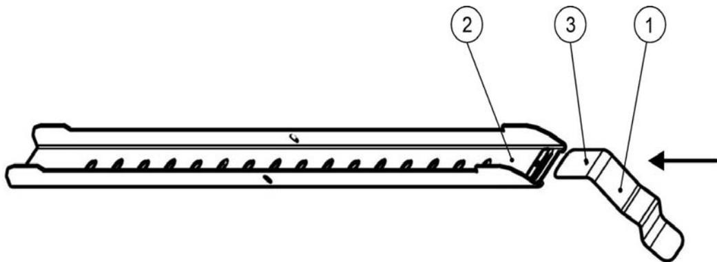
Abbildung 5-1 Einsetzen der Haltefeder in das Tragprofil
