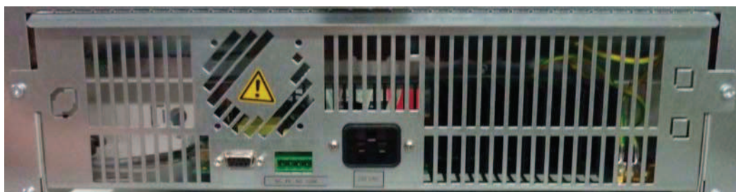
Рисунок 4-16 Разъемы сигнальных интерфейсов и разъем питания
