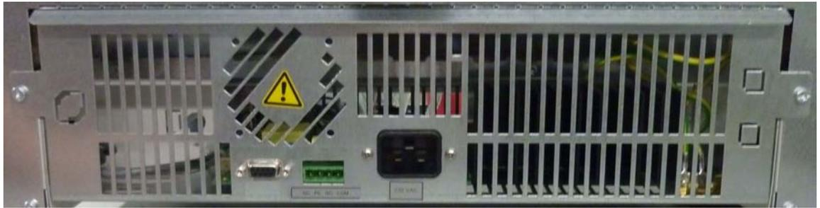
**Figura 5-9 Presa di collegamento alla rete**
