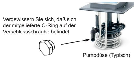
**Zur Beachtung:** Es befindet sich eine zweite verschlossene Öffnung am Pumpengehäuse. Entfernen Sie diesen Verschluss nicht, da Reservoirflüssigkeit das Bad überfluten könnte. ▲
