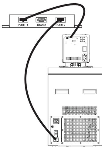
1. Wenn das Gerät bereits mit einem Kommunikationskabel versehen ist, entfernen Sie das Kabel von der Rückseite des Einhängethermostats, und stecken Sie dieses Kabel in PORT 2 am Adapter.
