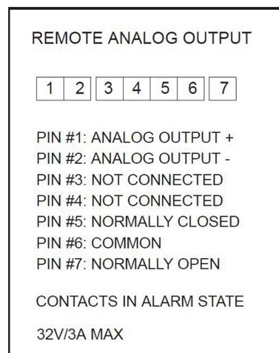
**Figura 2. Configurazione piedini allarme remoto**
