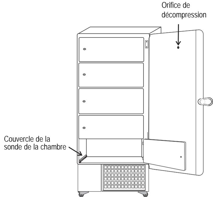
**Figure 1-4.** Emplacement de l'orifice de décompression et du couvercle de la sonde
