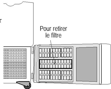
**Figure 4-1.** Grille avec emplacement du filtre
