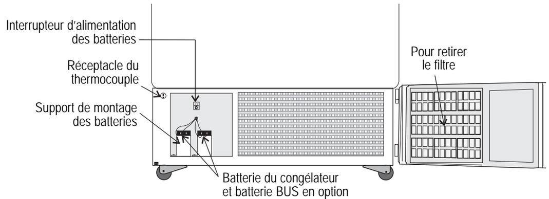
**Figure 1-5.** Emplacement des batteries et de l'interrupteur
