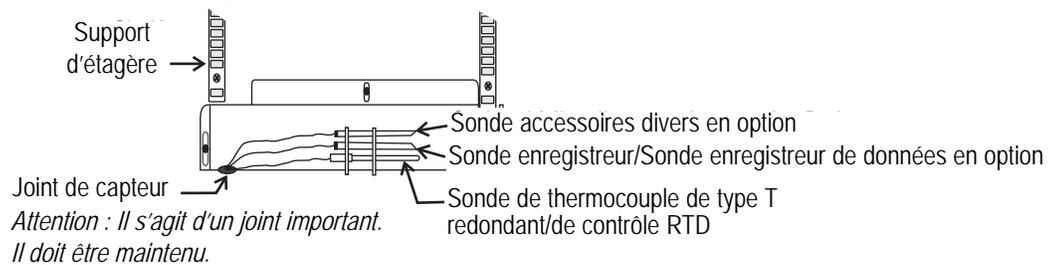
**Figure 1-3.** Sonde(s) de la chambre
