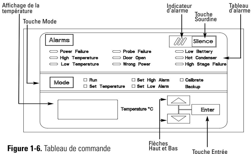
**Figure 1-6.** Tableau de commande
