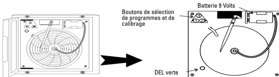
Figure 5-8. Détails sur l'enregistreur
