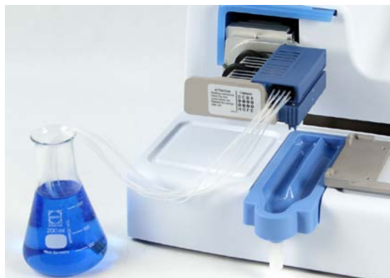
图 4-20.带分液头和集线器保护的的分液盒已移除, 以及试剂容器内的集线器
