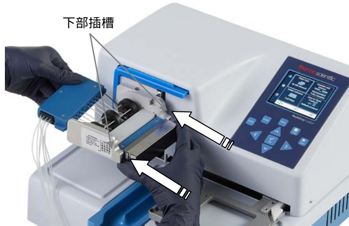
图 4-14.将分液盒下部插入其插槽
