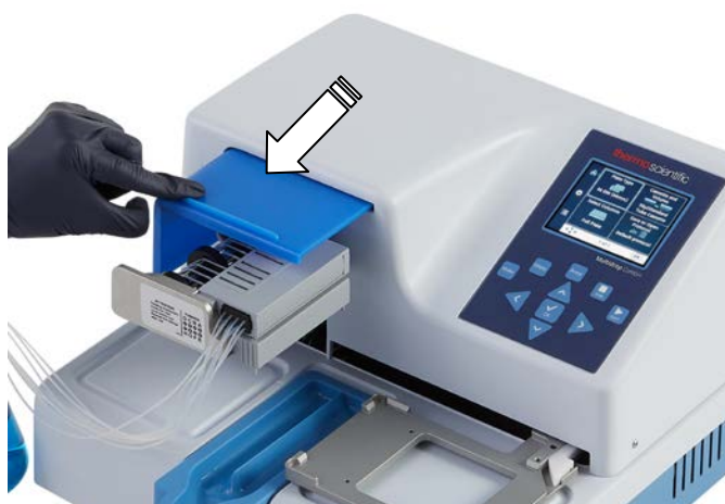
图 4-22.将转子盖拉到转子上
