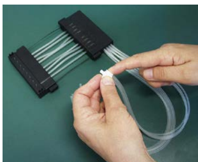
图 5-55.将管体插入 PEEK 集线器
