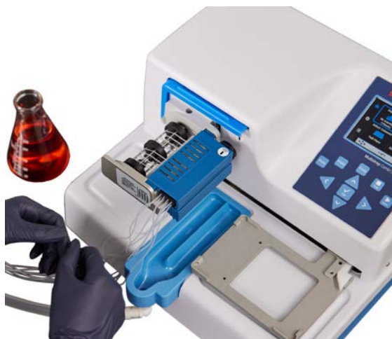
图 6-57.分液盒已正确安装
