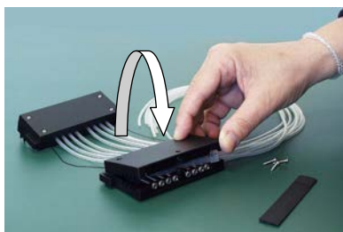
图 5-47. 更换分液盒上部的盖板
