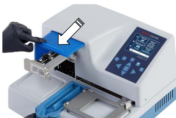
图 3-9.将转子盖拉到转子上
