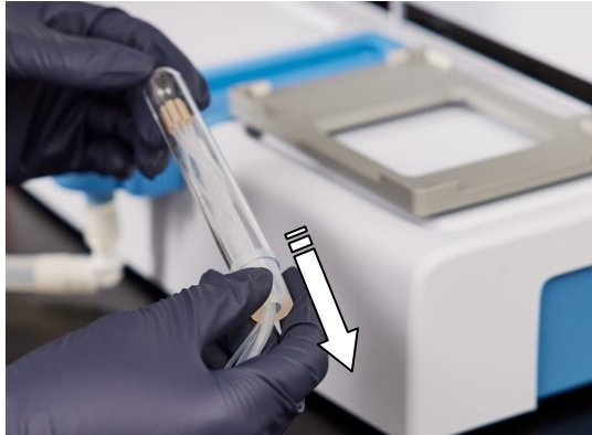
图 4-19. 移除集线器保护和橡胶固定架
