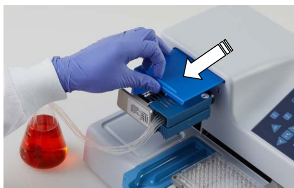
图 6-58.将转子盖拉到转子上
