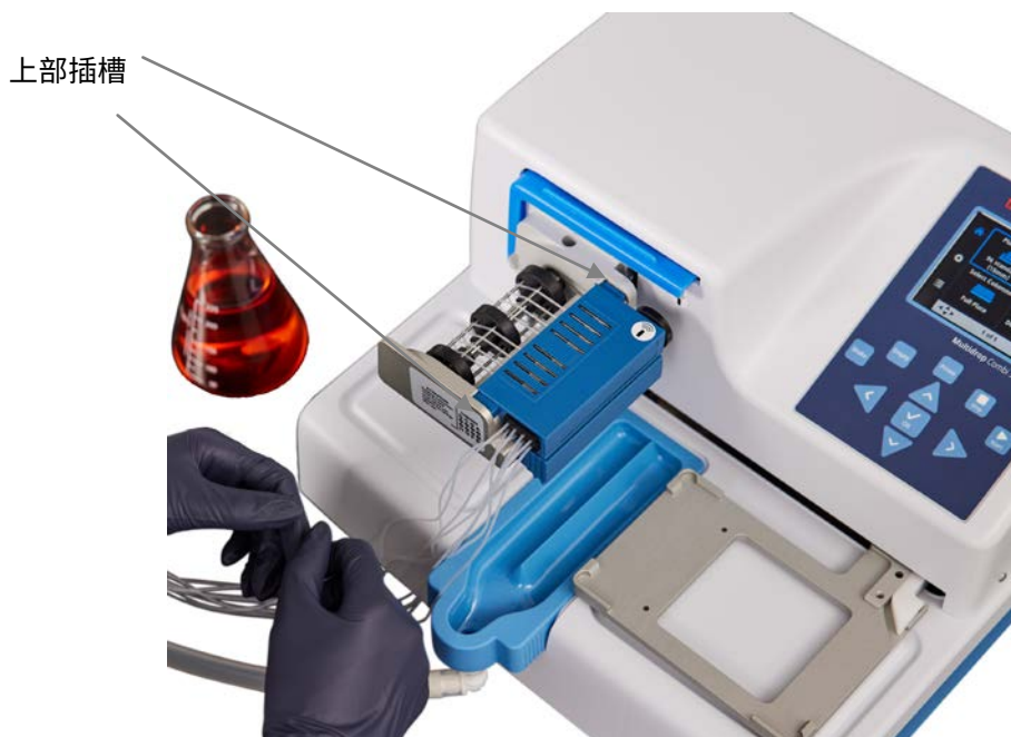
图 4-16. 将插入的分液盒上部平稳地下降至其插槽位置
