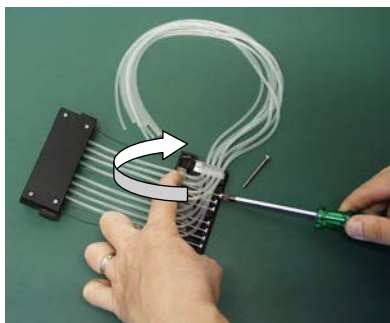
图 5-45. 紧固校准螺钉
