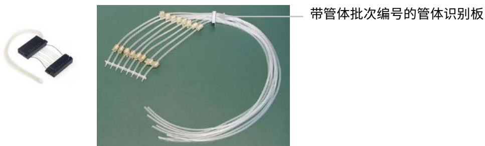
图 5-35. 分液头夹带装好的新管体组件
