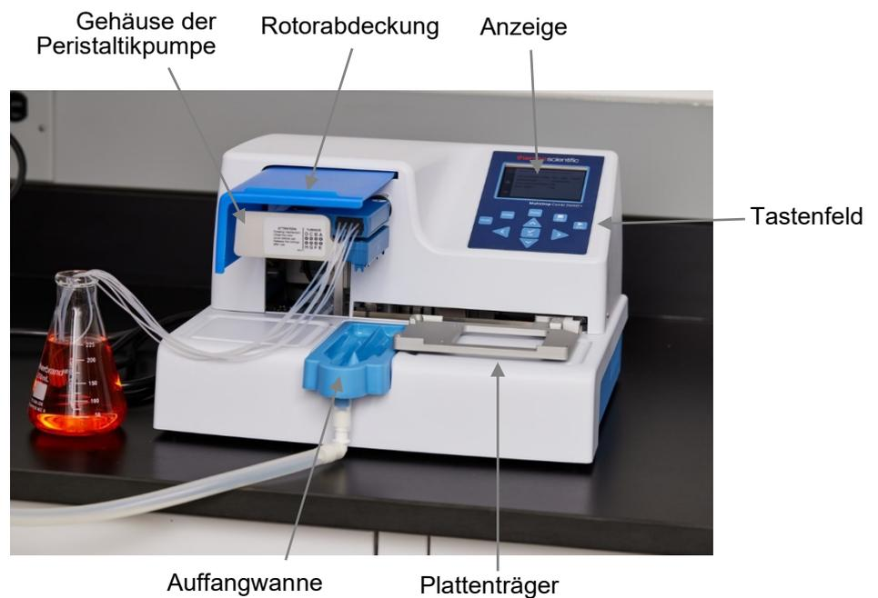
**Abbildung 2–2.** Frontansicht des Instruments
