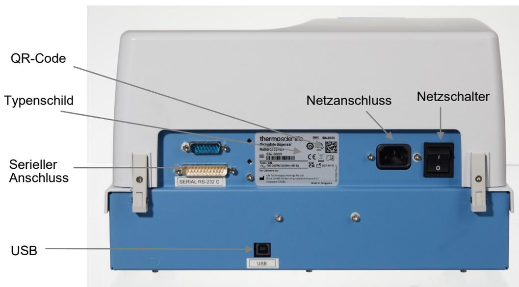
**Abbildung 2–4.** Rückansicht des Instruments
