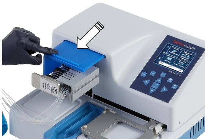
**Abbildung 4–22.** Die Rotorabdeckung über den Rotor ziehen
