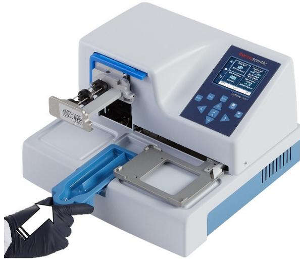
Abbildung 3–8. Einsetzen der Auffangwanne
