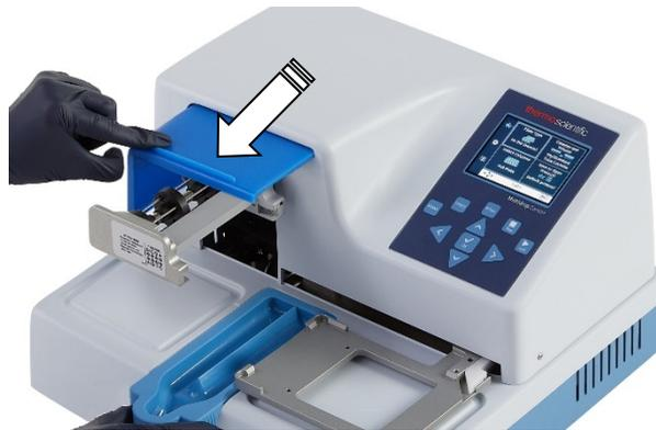
Abbildung 3–9. Die Rotorabdeckung über den Rotor ziehen
