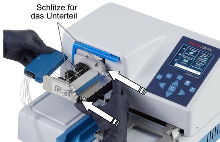
**Abbildung 4-14.** Einsetzen des Unterteils der Dispensierkassette in die dafür vorgesehenen Schlitze
