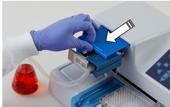
**Abbildung 6–58.** Die Rotorabdeckung über den Rotor ziehen
