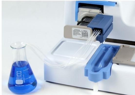
**Abbildung 4–20.** Kassette mit abgenommenen Schutzvorrichtungen für Spitze und Schlauchgewicht und dem Schlauchgewicht im Reagenzienbehälter
