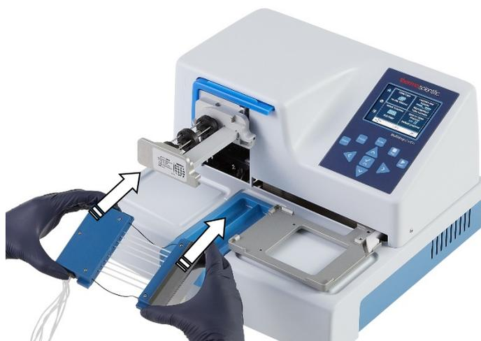
Abbildung 4-13. Einsetzen der Dispensierkassette
