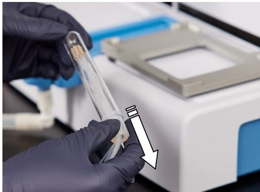
**Abbildung 4–19.** Entfernen des Schlauchgewichtsschutzes und der Gummihalfterung
