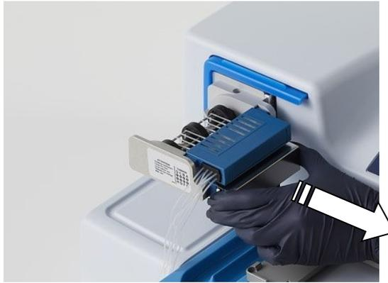
**Abbildung 4–18.** Abziehen des Spitzenschutzes von der Dispensierkassette
