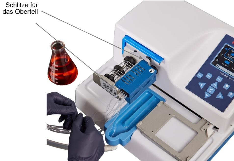
**Abbildung 4–16.** Unter- und Oberteil der Dispensierkassette gleichmäßig in ihre Schlitze eingesetzt
