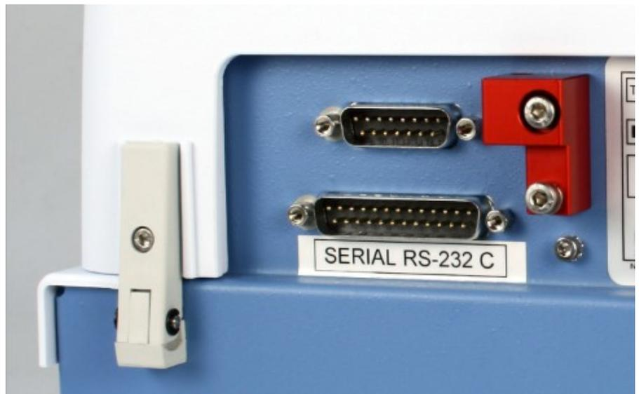
**Abbildung 3–7.** Lagerung der Transportsicherung
