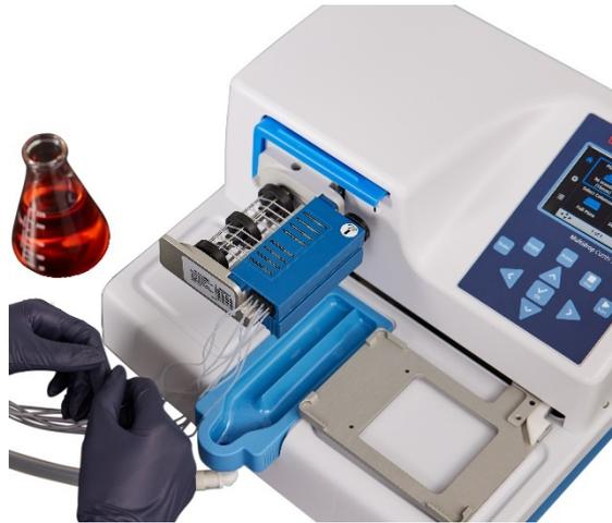
**Abbildung 6–57.** Dispensierkassette korrekt installiert
