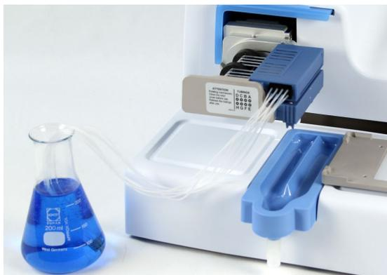
**Figura 4–20.** Cassetta con protezioni dei puntali e del terminale del set di tubi rimosse e terminale del set di tubi nel contenitore del reagente
