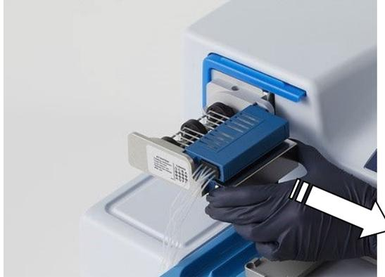
**Figura 4–18.** Rimozione della protezione dei puntali dalla cassetta di dispensazione
