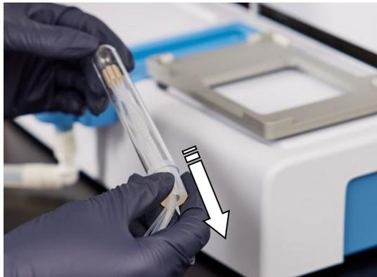
**Figura 4–19.** Rimozione della protezione del terminale del set di tubi e del supporto in gomma
