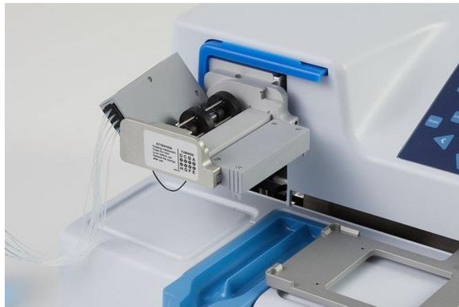
**Figura 5–29.** Posizione di riposo della cassetta di dispensazione
