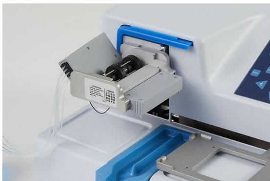
**Figura 4–21.** Posizione di riposo della cassetta di dispensazione
