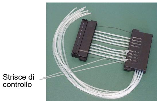
**Figura 5–52.** Cassetta di dispensazione prima della calibrazione
