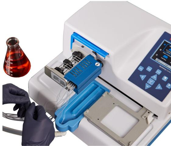
**Figura 6–57.** Cassetta di dispensazione correttamente installata
