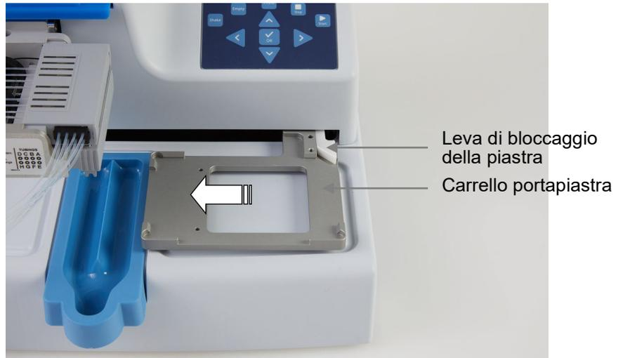
**Figura 3–10.** Controllo della leva di bloccaggio della piastra
