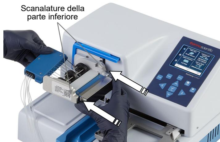
**Figura 4-14.** Inserimento della parte inferiore della cassetta di dispensazione nelle relative scanalature
