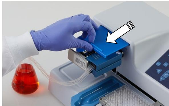
**Figura 6–58.** Coperchio del rotore tirato sopra il rotore
