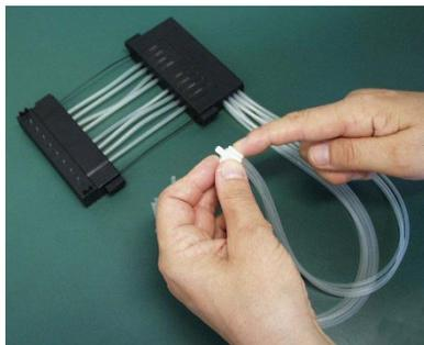
**Figura 5-55.** Inserción de los tubos en el lastre PEEK
