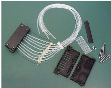
**Figura 5-41.** Elementos de la pieza superior del casete dispensador
