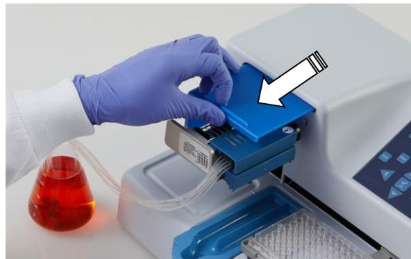
**Figura 6-58.** Tire de la cubierta del rotor sobre el rotor
