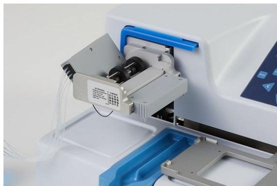
**Figura 4-21.** Posición de reposo del casete dispensador
