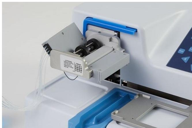
**Figura 5-29.** Posición de reposo del casete dispensador
