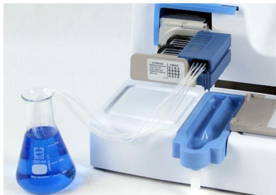
**Figura 4-20.** Casete con los protectores de puntas y lastres quitados y con el lastre de tubos introducido en el recipiente de reactivo
