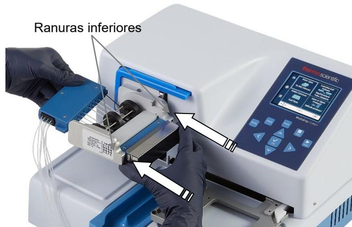
**Figura 4-14.** Insertar la pieza inferior del casete dispensador en sus ranuras
