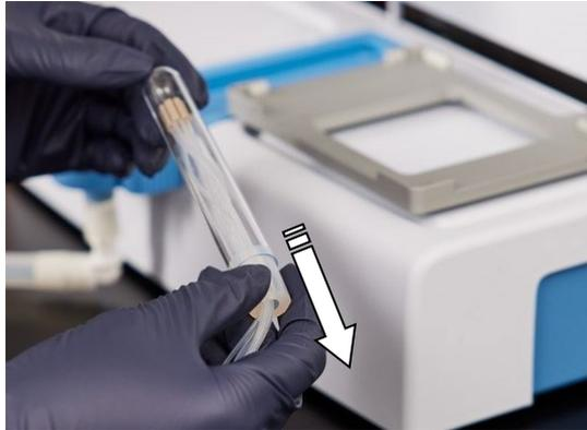
**Figura 4–19.** Retirada del protector de lastres y del soporte de goma
