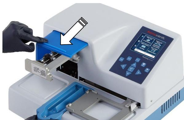
Figura 3-9. Tire de la cubierta del rotor sobre el rotor
