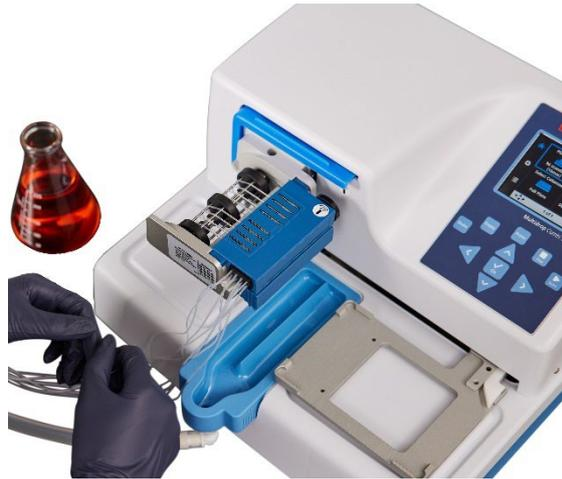
**Figura 6-57.** Casete dispensador correctamente instalado
