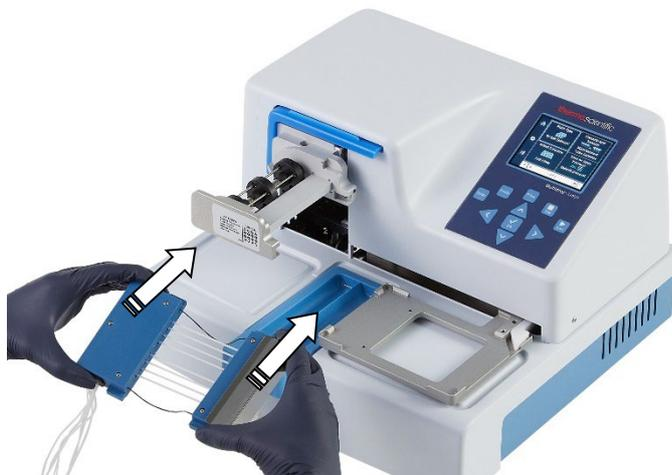
Figura 4–13. Insertar el casete dispensador
