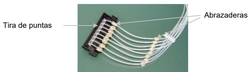
**Figura 5–36.** Inserción de la tira de puntas en la pieza inferior del casete dispensador
