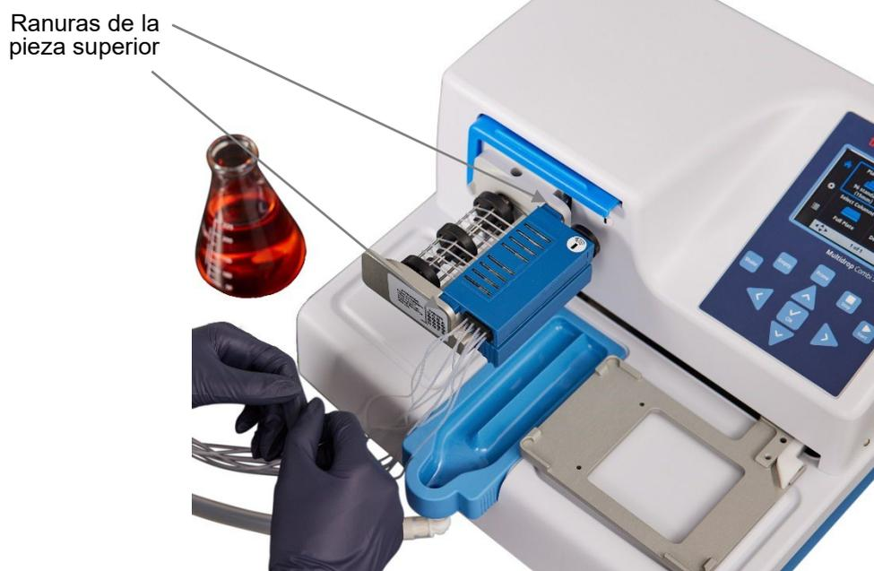
**Figura 4–16.** Las piezas inferior y superior del casete dispensador se insertan uniformemente en sus ranuras
