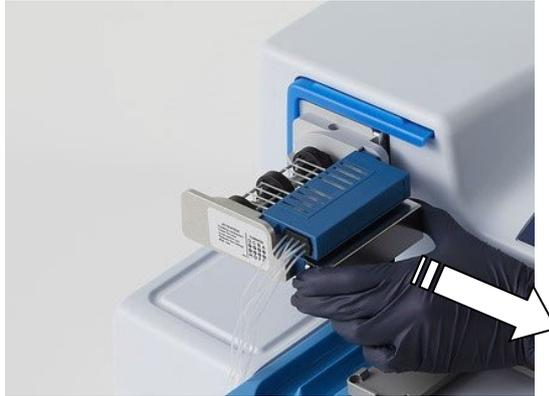
**Figura 4–18.** Sacar el protector de puntas del casete dispensador
