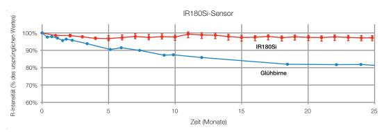
Abbildung 2: Ein herkömmlicher Infrarotsensor enthält eine Glühbirne, die im Laufe der Zeit weniger Licht abstrahlt, sodass Messwertabweichungen auftreten (Sensordrift). Beim IR180Si-Sensor ist dies nicht der Fall. Die MEMS-Emittertechnologie ist langzeitstabil. Ihre Lebensdauer ist bis zu 50 % länger als die herkömmlicher IR-Sensoren.
