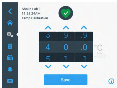
Kuva 112: Kalibrointi: Ravistimen näyttämä oikea lämpötila
