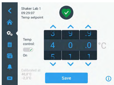
그림 33: 온도 설정값: 보정 판독이 표시된 화면
