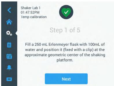
Figur 108: Kalibrering: Skjerminnstrukser for påfylling av Erlenmeyer-flasker
