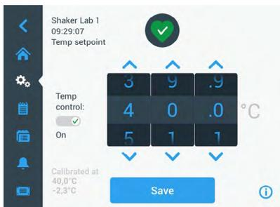
图 33: 设置温度设定点: 带有校准读数的屏幕
