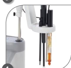
Verwenden Sie den Titrator mit Premium ROSS pH-Elektrodenteknologie um ein vollständiges, optimiertes Messsystem für genaue und reproduzierbare Probenanalysen zu erhalten.
