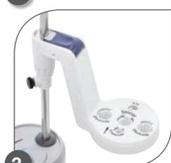
Der Elektrodenhalter ermöglicht das sichere, reibungslose Bewegen der Elektroden während des gesamten Messvorgangs.
