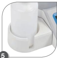
Le porte-bouteille aide à sécuriser le titrant pour éviter les déversements et peut être facilement déconnecté du titreur pour plus de souplesse dans l'aménagement de la paillasse.
