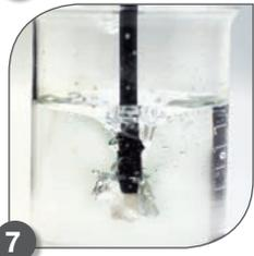
Sonde d'agitation assurant un mélange homogène, sans détérioration des électrodes et facile à rincer entre les échantillons.
