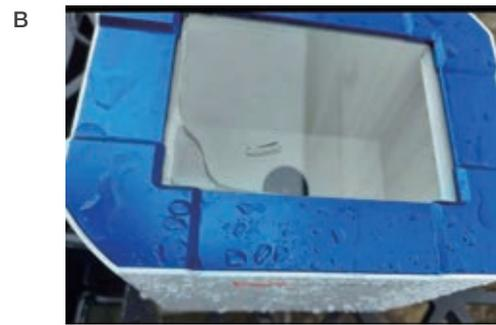
図2.水侵入試験前後のVisionMate HSX High Speed 2Dコードリーダー (A:試験前、B:試験後)。検査後の拡大画像中の水に注目
