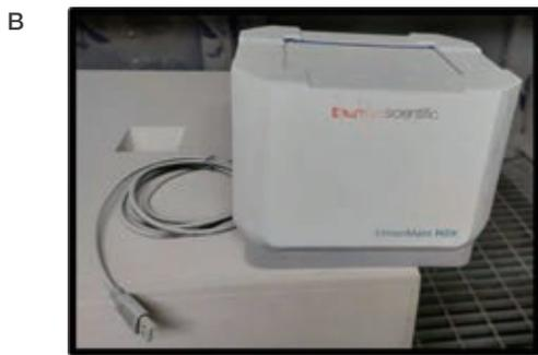
図1.異物侵入試験前後の塵埃チャンバー内のVisionMate HSX High Speed 2Dコードリーダー (A:試験前、B:試験後)。試験後の装置を覆うパウダーに注目
