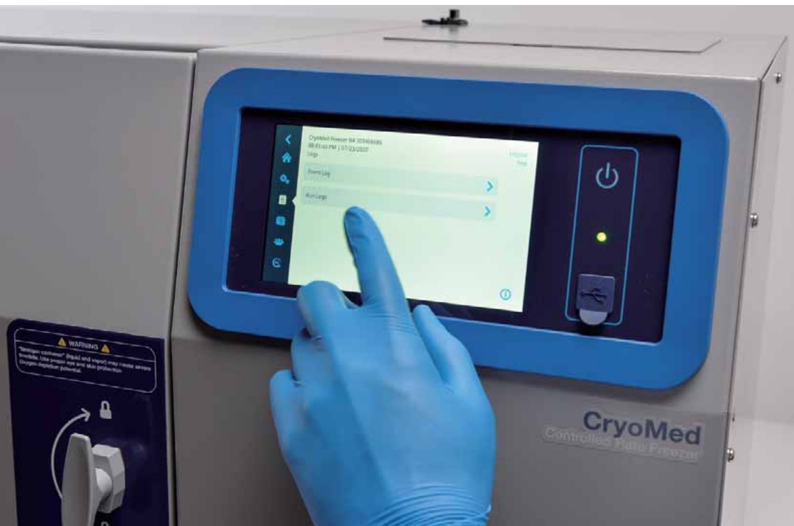
图2.程控降温仪，如Thermo Scientific™ CryoMed™程控降温仪，有助于管理低温保存过程，以确保达到最佳参数。有关使用CryoMed程控降温仪的更多详细信息，请阅读此智能说明
