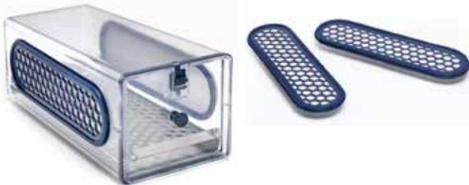
Der austauschbare 0,2-µm-Membranfilter mit einer effektiven Porengröße von ca. 0,02 µm zum Filtern von Luft<sup>1</sup> ist hydrophob, oleophob, beständig gegen organischen Lösungsmitteln sowie auf Biosicherheit und niedrige Zytotoxizität getestet.
