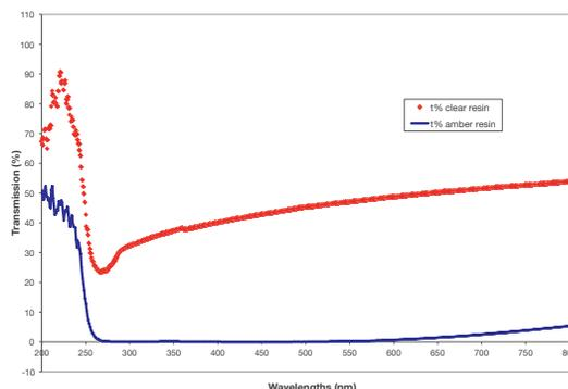
褐色とクリアの両材質はUV波長領域を透過します。クリアは200~800 nm波長範囲を透過し、褐色は270~600 nmの範囲ではほぼ0%透過率であり、600~800 nmでは若干の透過率を示します。
