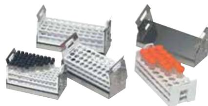
通用试管架夹持器可调节, 以符合 4 种尺寸中任何大小的可用试管架。通用设计要求单独购买试管架。
