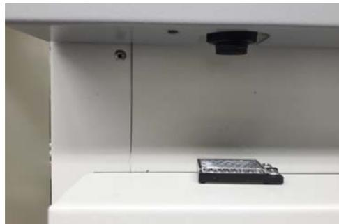
Figure 5-2 Interrupteur de porte activé par la protection contre la lumière
