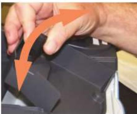
插入 - 让前磁铁啮合。降低比色皿架使其到位，让后磁铁能够引导并啮合
