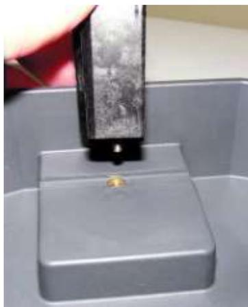
松开固定螺丝和比色皿架底座，将其拆下。用同样的方法连接一个新的样品托架。
