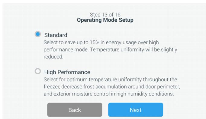
**Figure 23. Écran Operating Mode Setup (Configuration du mode de fonctionnement)**
