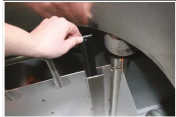
Insertion d'une jauge de mesure pour mesurer le niveau physique d'azote liquide.
