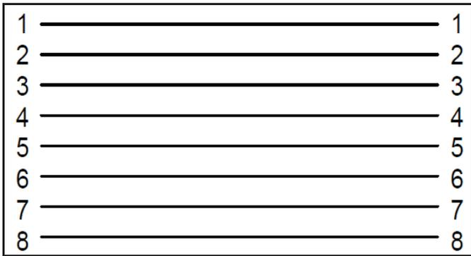
**Figure 16. Configuration de câble réseau RJ-45 standard inversé. Numérotation vue du côté du connecteur opposé au verrou.**
