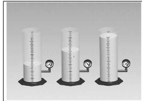
**Figure 3. Lorsque le niveau de fluide dans le cylindre augmente, la pression de refoulement imposée au fond du cylindre augmente proportionnellement. Les manomètres mesurent cette augmentation de niveau.**
