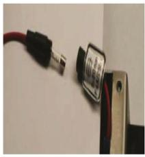
**Remarque:** Ne connectez pas la batterie de secours au faisceau de câbles principal tant que l'alimentation n'a pas été vérifiée pour mettre le contrôleur sous tension.
