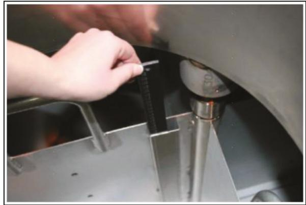
Peilstab zur Messung des physikalischen Flüssigstickstoff-Füllstands
