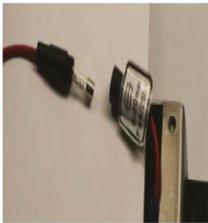
**Hinweis:** Schließen Sie die Backup-Batterie erst dann an den Hauptkabelbaum an, wenn die Stromversorgung der Steuereinheit überprüft wurde.
