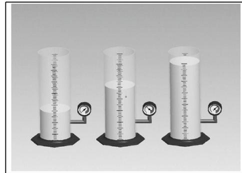
**Abbildung 3. Der am Boden des Zylinders ausgeübte Kopfdruck steigt proportional mit zunehmenden Füllstand im Zylinder. Die Manometer messen anhand dieses Werts den Anstieg des Füllstands.**
