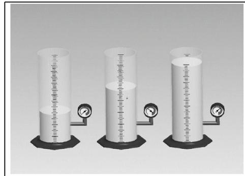
**Figura 3. A medida que el nivel de líquido en el cilindro aumenta, la carga de presión impuesta en el fondo del cilindro aumenta proporcionalmente. Los manómetros miden este incremento en el nivel.**
