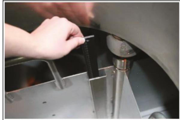
Regla graduada insertada para medir el nivel físico de nitrógeno líquido
