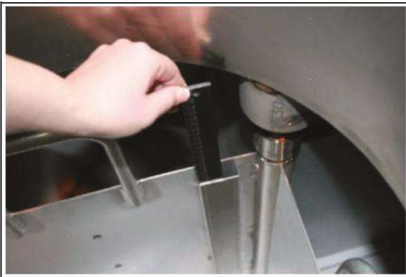
Asta di livello inserita per misurare il livello fisico di azoto liquido.
