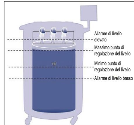
**Figura 4. Esempio dei parametri di controllo del livello automatico**
