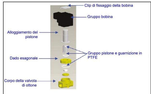
**Nota:** Se si rende necessaria la sostituzione del corpo della valvola in ottone, bisognerà smontare il sistema idraulico del congelatore e sostituire tutta la valvola (PN 14224611S). In genere, il modo più semplice è smontare il gruppo idraulico partendo dal raccordo a T per sostituire la valvola di rifornimento o dal silenziatore di bypass del gas per sostituire la valvola di bypass del gas.
