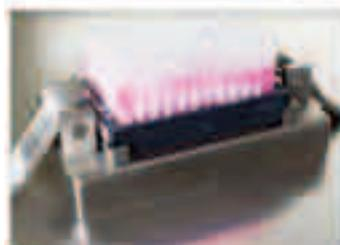
Nunc冻存管选择工具的底座特殊设计，可以保证冻存管架放置方向与工具底座方向的一致性。杠杆配合底座的金属凸起小块可以方便地获得目的样品冻存管。
