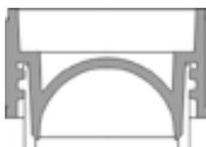
圆顶式密封螺纹盖
