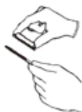
垫圈的去除。将刀片的一头或类似工具插入到垫圈的一角。轻轻将其提离载玻片，不要拉伸或者撕扯垫圈。
