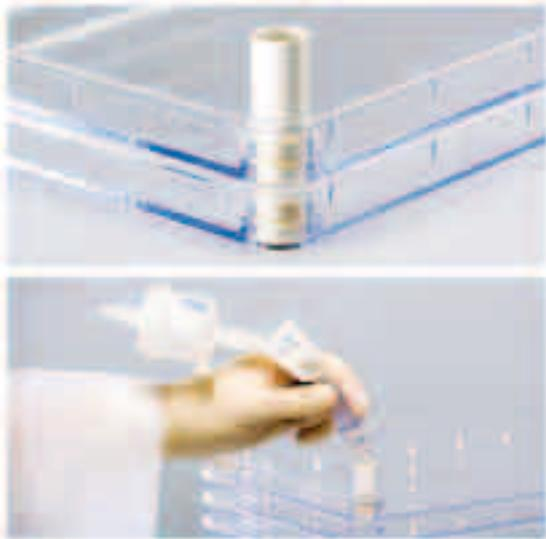
PLUG通过我们提供的连接器，可以轻松地将普通的培养基容器连接到细胞工厂。提供GMP生产标准的半封闭系统。
