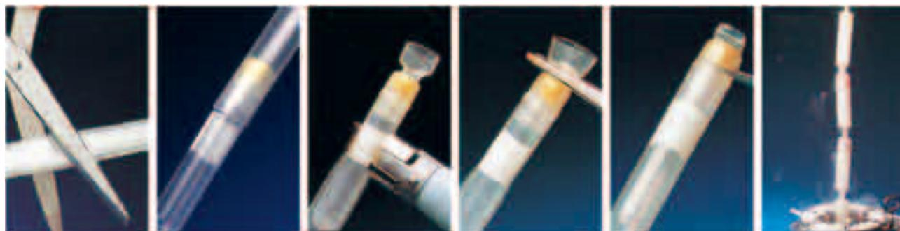
为冻存管两端剪出足够的CryoFlex塑料管
