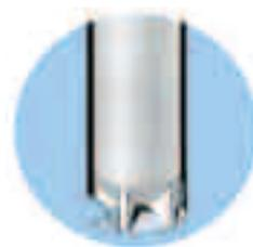
星形脚冻存管与CryoTube冻存管架（目录编号：376589）的凹槽相匹配，可以单手进行操作
