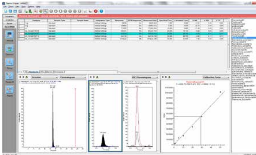
图 6 41 种激素分析结果图（从左至右，分别为 TIC，定量离子图，离子比率图，标准曲线图）
