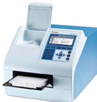
在Multiskan GO的光路设计中，应用最新一代单色器，可以生成 $< 2.5\text{nm}$ 的测量带宽，从而确保出色的光谱分辨率。双光束光学系统，包括内建的参比检测通道，确保任何测量情况下获得一致的结果。仪器启动后自动进行诊断程序，对光源、单色器、检测器、载板位置等进行检查，确保仪器运行的稳定可靠。
