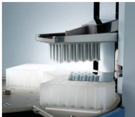
KingFisher技术的工作原理如下图所示，样品、溶液和磁珠置于微孔板或管中，磁棒表面套有专门的磁套用于保护磁棒避免与样品/溶液/磁珠直接接触。磁棒的工作模式可以分为以下四种(以样品管为例)：
