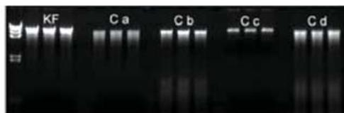
KingFisher plant DNA提取试剂盒(KF)和其他四种磁珠提取试剂盒(Ca-Cd)在KingFisher Flex上以同样的体系各从50mg新鲜的烟草叶子中提取gDNA电泳图, 结果显示KingFisher Plant DNA提取得到的DNA得率最高, 纯度最好
