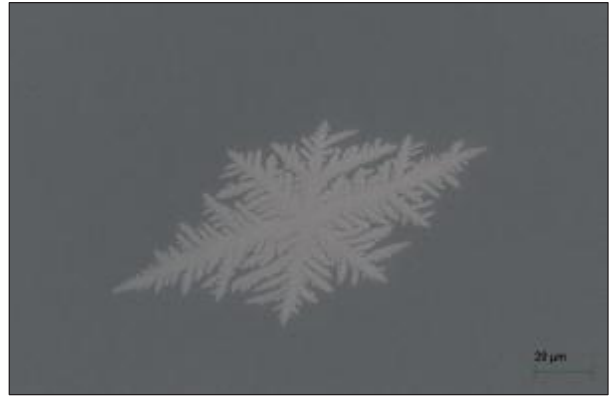
图 1: Cu (111) 上树枝状石墨烯生长的 SEM 图像，其中 Cu (111) 由氢对甲烷通量比较低的低压 CVD 合成。
