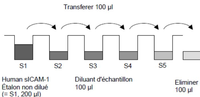
Dans le cas d'**une dilution d'étalon externe** (voir 4.4.1), pipeter 100 µl de ces dilutions d'étalon (S1 –S5) dans les puits de façon montrée dans Tableau 1.
