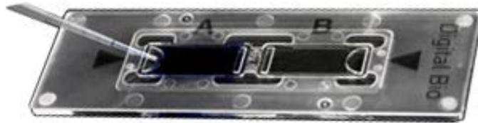
**Nota:** Cada cámara del portaobjetos de cámara para el recuento celular Countess™ tiene una capacidad de 10 µl para la muestra. No llene en exceso las cámaras del portaobjetos.
