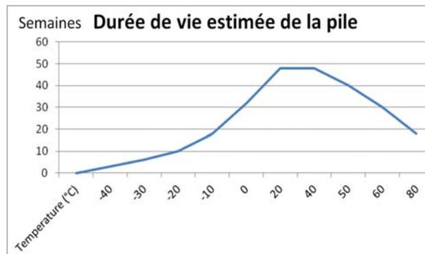
**Figure 29. Estimation de la durée de vie de pile pour le module  $-40^{\circ}\text{C}$  à  $+85^{\circ}\text{C}$**
