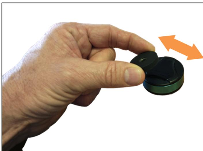
Figure 6. Utilisation de l'aimant pour contrôler l'état du module Smart-Tracker
