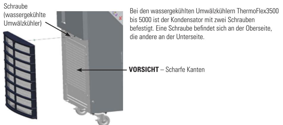
**Abbildung 6-3** Entfernen des Kondensatorgitters bei ThermoFlex900 bis 5000
