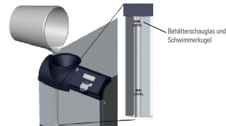
**Abbildung 3-8** Behälterschauglas und Schwimmerkugel
