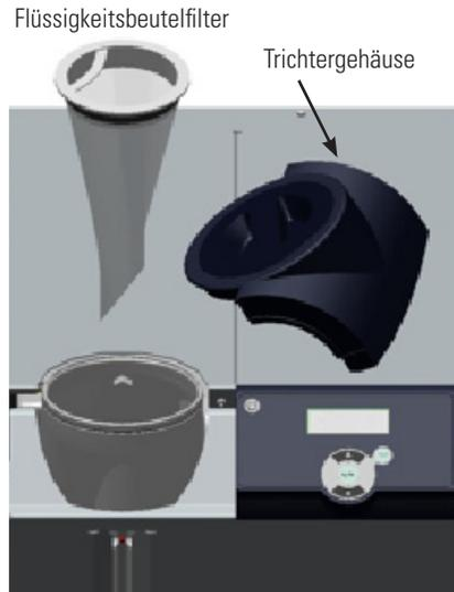
Wenn der Beutel ausgewechselt werden muss, ziehen Sie das Kunststoff-Trichtergehäuse vorsichtig nach oben, um es zu entfernen, und ziehen Sie den Beutel einfach aus dem Umwälzkühler heraus. Ersatzbeutel können von Thermo Fisher Scientific bezogen werden.
