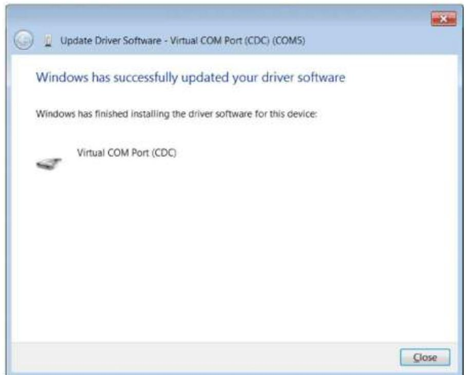
11. L'instrument de mesure peut désormais transférer des données à l'ordinateur à l'aide du port Virtual COM et du logiciel Orion Star Com, HyperTerminal ou autre programme similaire.
