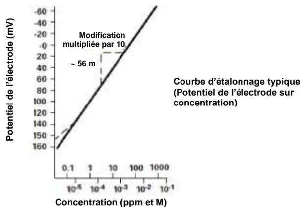
Ce blanc peut être un blanc de réactif véritable, des traces d'ions analates dans les réactifs, ou bien il peut s'agir de la valeur de "boue" de l'électrode. Il peut également s'agir d'une interférence dans les réactifs devenant visible à de faibles niveaux d'ions analates, ou encore d'une combinaison de ces effets. La version étendue de l'équation de Nernst traditionnellement utilisée pour la correction de blanc est la suivante :
