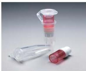
Microcon<sup>®</sup> Centrifugal Filter Units
