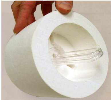
Figure 10–16. Tube du pyrolyseur inséré dans l'isolation
