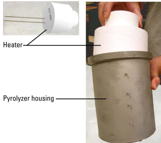
Figure 10-7. Insérez l'élément chauffant de rechange dans le boîtier.
